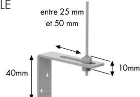
**ⓘ** Cette option dispose d'un ressort dans la partie supérieure du câble afin de maintenir le câble toujours tendu. Les fixations du guidage maintiennent une tension entre le câble et le plafond. C'est pourquoi, l'installation de ces options n'est possible que sur les plafonds dont la résistance a été vérifiée.
